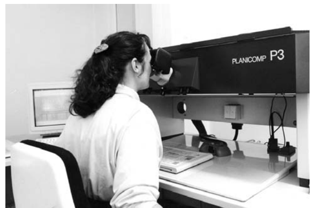
Abbildung 2: Arbeit am analytischen Stereoauswertegerät Planicom P3
